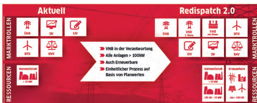
Abb. 2 Der Redispatch-Prozess beim Verteilnetzbetreiber (ÜNB: Übertragungsnetzbetreiber; VNB: Verteilnetzbetreiber; DV: Direktvermarkter; EIV: Einsatzverantwortlicher; BTR: Betreiber einer technischen Ressource; BKV: Bilanzkreisverantwortlicher)
